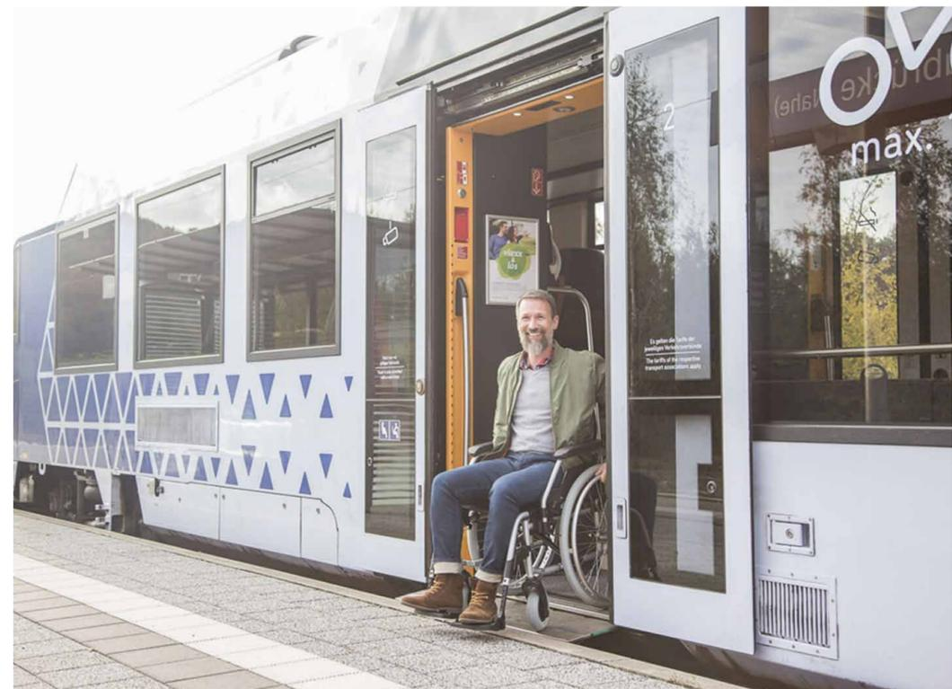
Ebenerdiger Ausstieg mit Spaltüberbrückung auf der Nahstrecke
